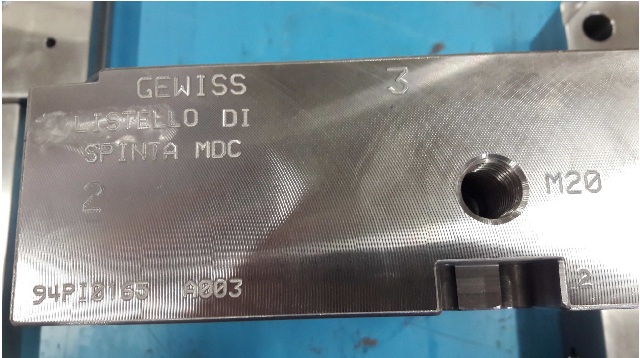
Fig. 1: descrizione equipment, identificazione fori per golfari, smussi esterno piastra description of equipment, identification holes for eyebolts, external chamfer plates.
