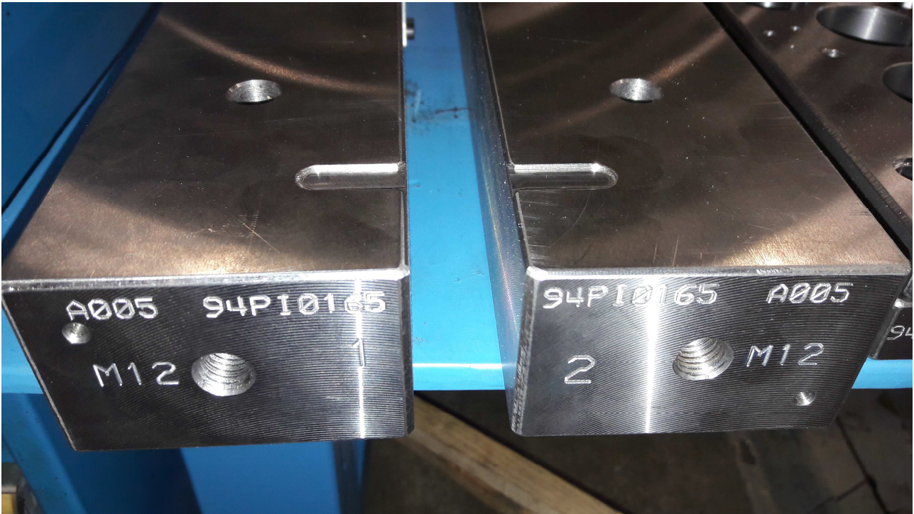
Fig. 3: identificazione distanziali e sedi golfari, scarichi aria per incolonnamento stampo identification spacers and eyebolts seats, air discharges for columns mold.
