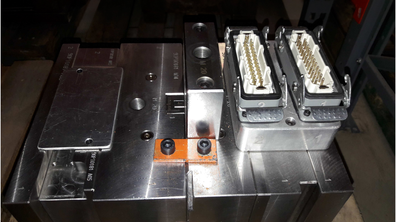
Fig.5: protezione tavolino, blocchetto per rialzare la sede del golfare extraction protection, block in order to raise the seat of the eyebolt.
